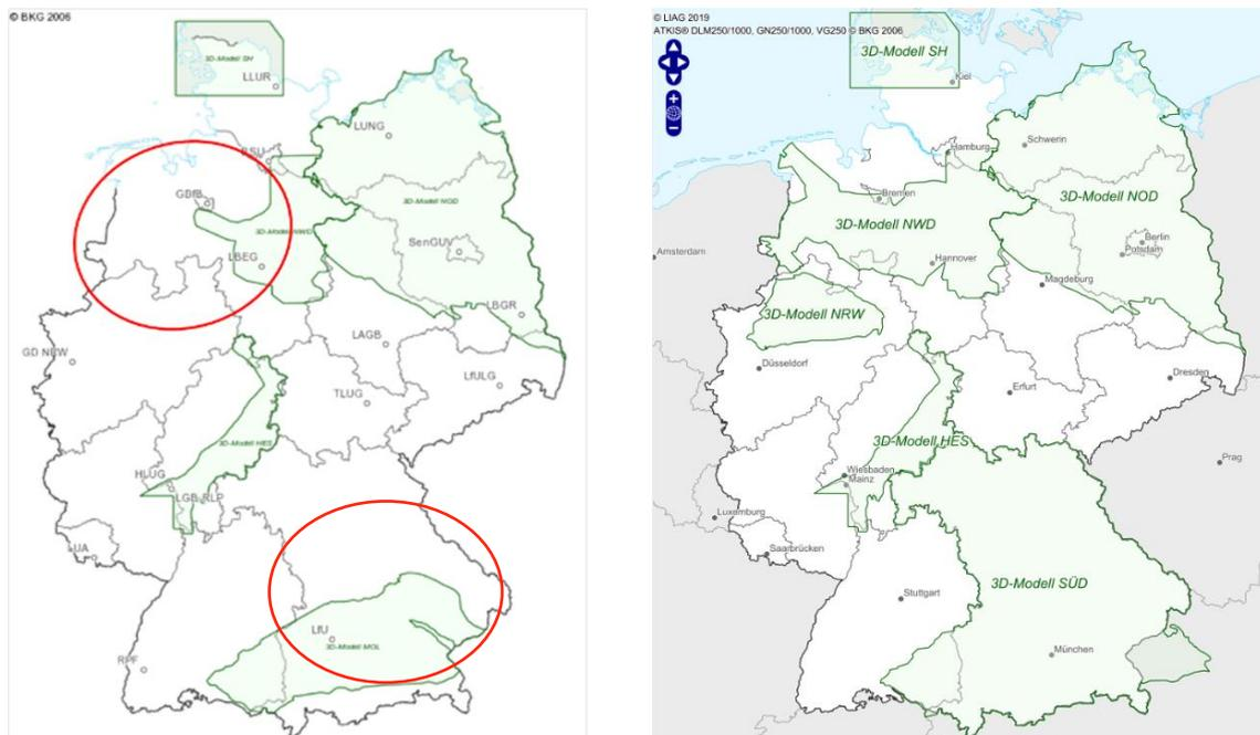
**Abb. 3.1:** Die über Internet aufrufbare Oberfläche von GeotIS; grün hinterlegte Flächen zeigen die Gebiete, in denen 3D-Modelle zur Verfügung stehen; die roten Markierungen zeigen Bereiche, in denen bisher keine 3D-Modelle vorlagen. Die Karte rechts zeigt den aktuellen Stand.
